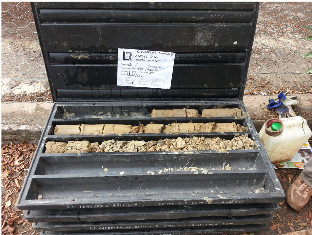
SONDAGGIO S2: Cassetta C2 da 5,00 m a 8,00 m
