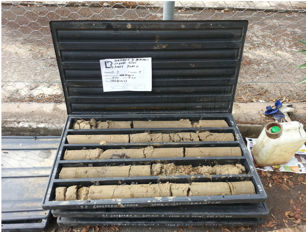
SONDAGGIO S2: Cassetta C1 da 0,00 m a 5,00 m
