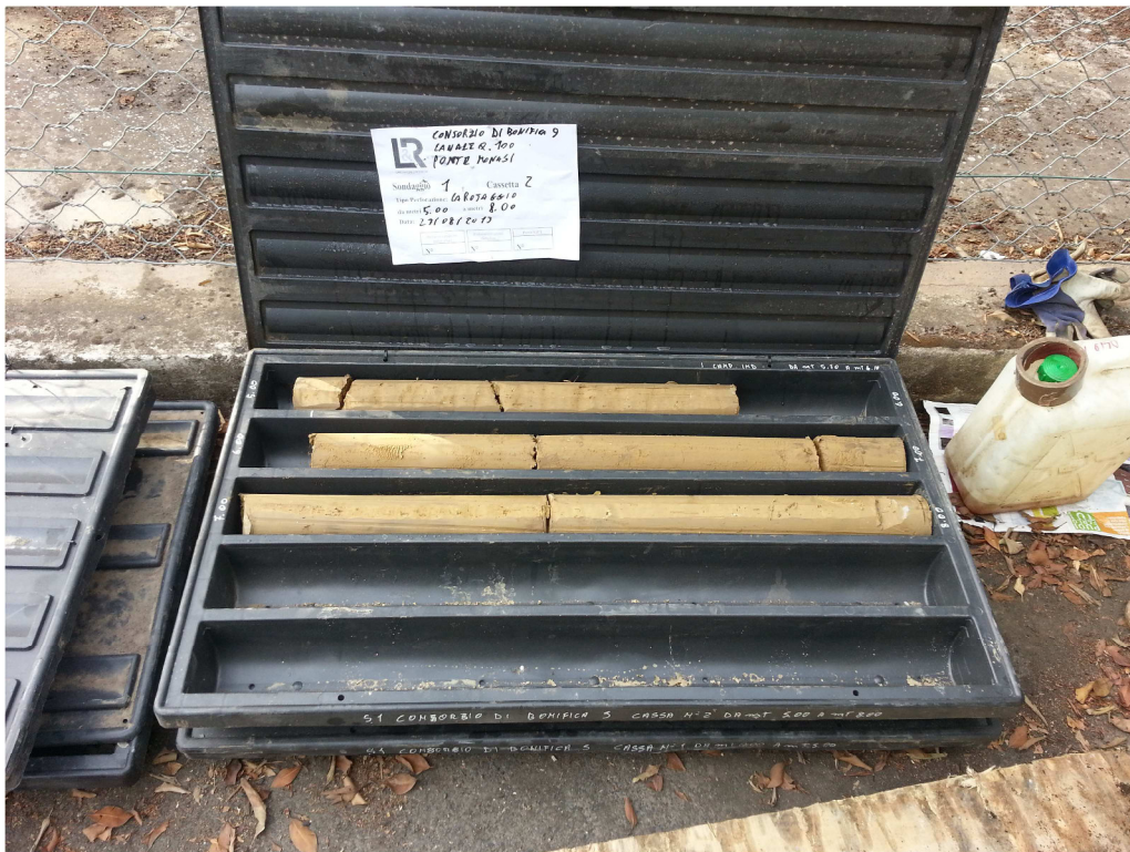
SONDAGGIO S1: Cassetta C2 da 5,00 m a 8,00 m
